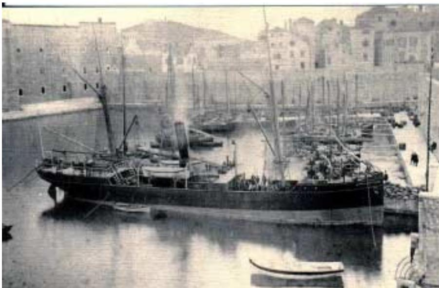
Prvi dubrovački parobrod, 1880. Razabire se krmeni statveni okvir i list kormila, a na vertikalnoj pramčanoj grednoj statvi - brojke zagaznica. Vitki cilindrični dimnjak, visoki jarboli i snast sa sošnim jedrima, nadgrađe bez izraženog zapovjedničkog mosta ... sve to pomaže *parnom došljaku* da manje remeti stoljetni sklad luke uz zidine Grada.
